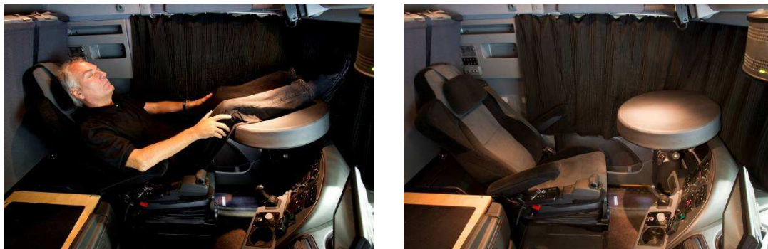
Bild 2: PowerNAP im ACTROS mit nach hinten geneigter Lehne und Lenkradkissen
